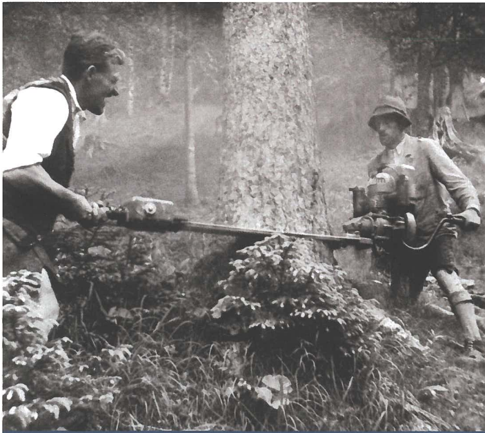
Bei der ersten Probe mit der Zwei-Mann-Motorsäge sind die vielen umher fliegenden Sägespäne für die Holzarbeiter noch völlig ungewohnt. Seither muss Augenschutz getragen werden.
