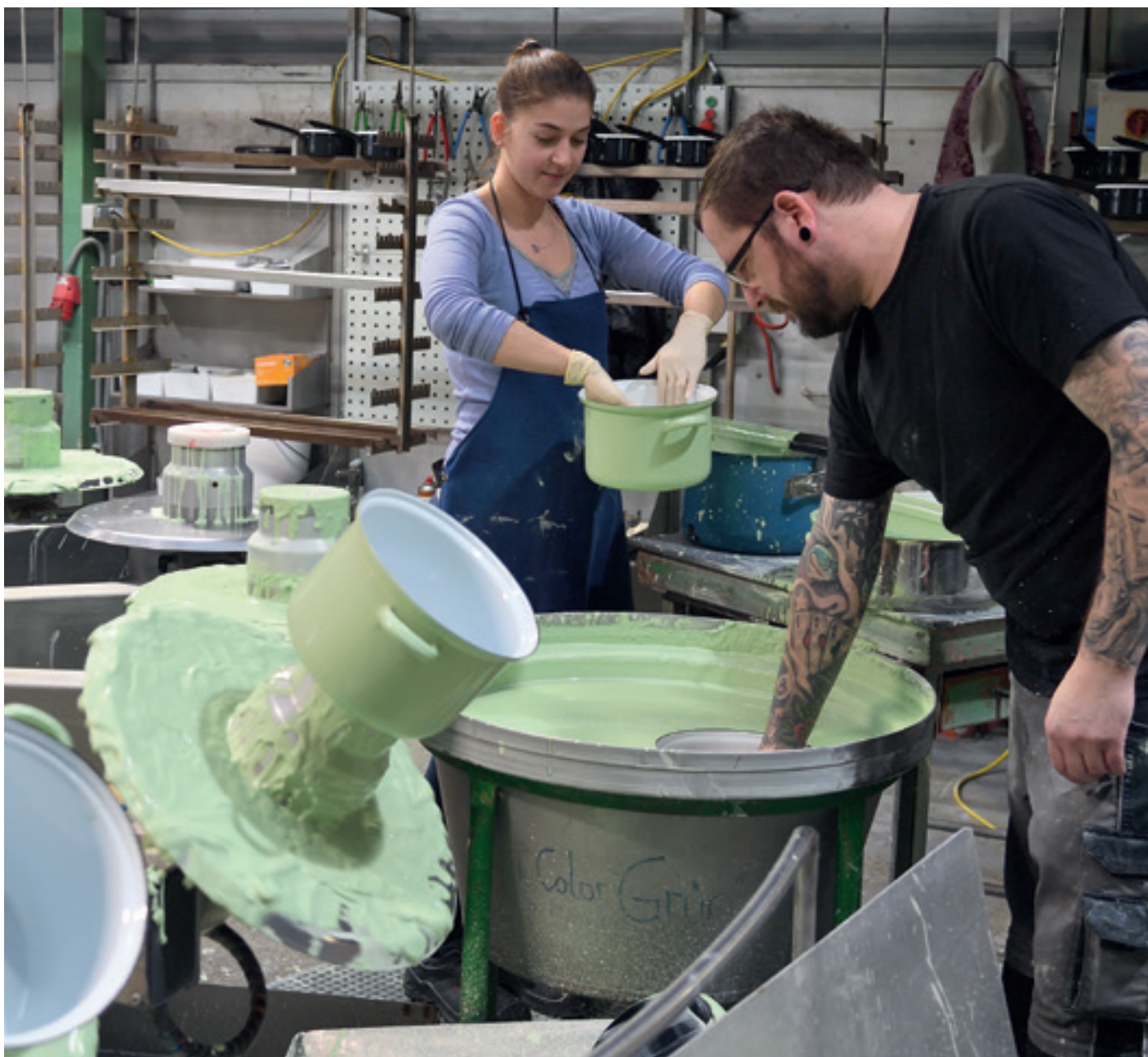
Damit sich die Farbe präzise verteilt, drehen sich die Töpfe im Kreis.
