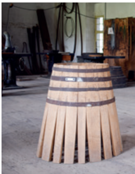
In der Werkstatt: ein halbfertiges Fass.
